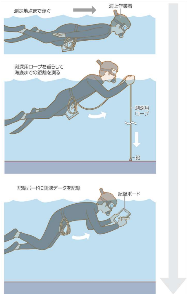
図3 ロープを用いた測深のイメージ
